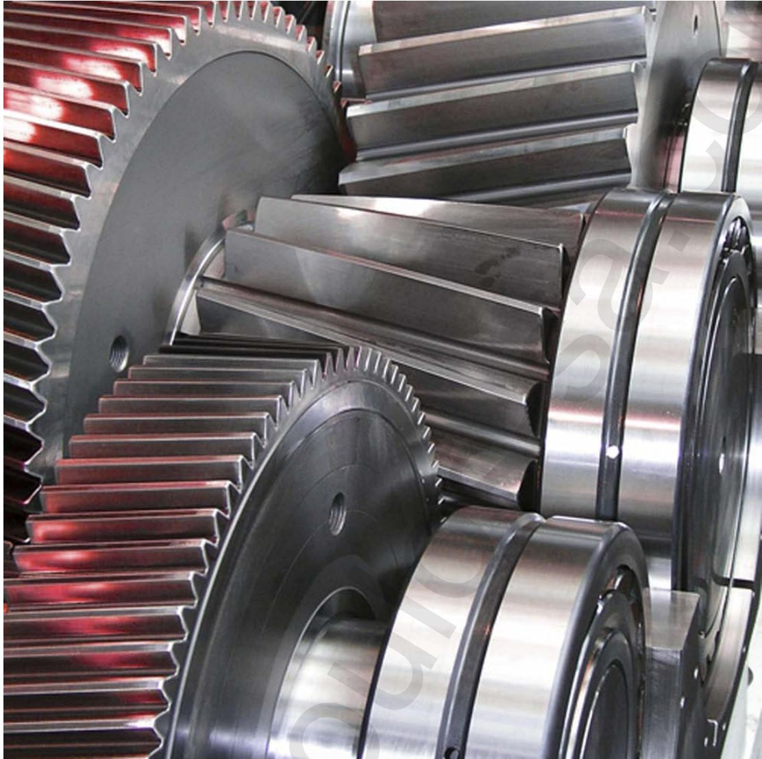
Ρουλεμαν μεγάλου μεγέθους κιβωτίου ταχυτήτων σε θέση εργασίας
